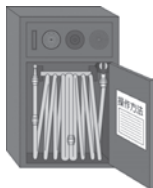
屋内消火栓設備
