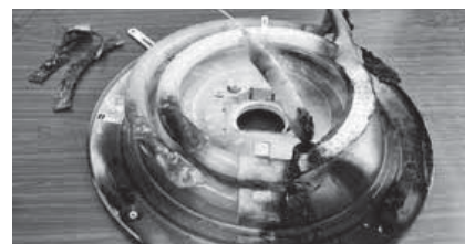
▲LED ランプの基盤が焼損
