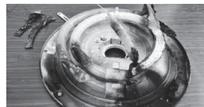
▲LED ランプの基盤が焼損
