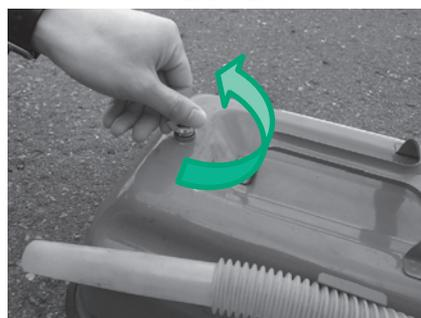
▲ねじを緩めて缶内の圧力を抜きます
