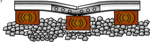
③レールをジャッキで持ち上げ、まくらぎ下部に道床をタイタンパでつき固める。
