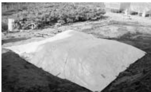
断熱シートで覆われた貯雪槽
